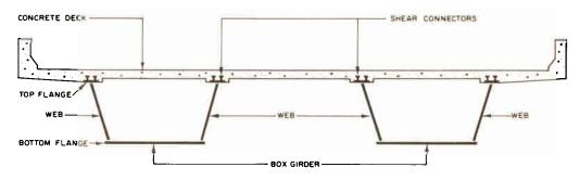
CROSS SECTION OF TYPICAL BOX-GIRDER BRIDGE
